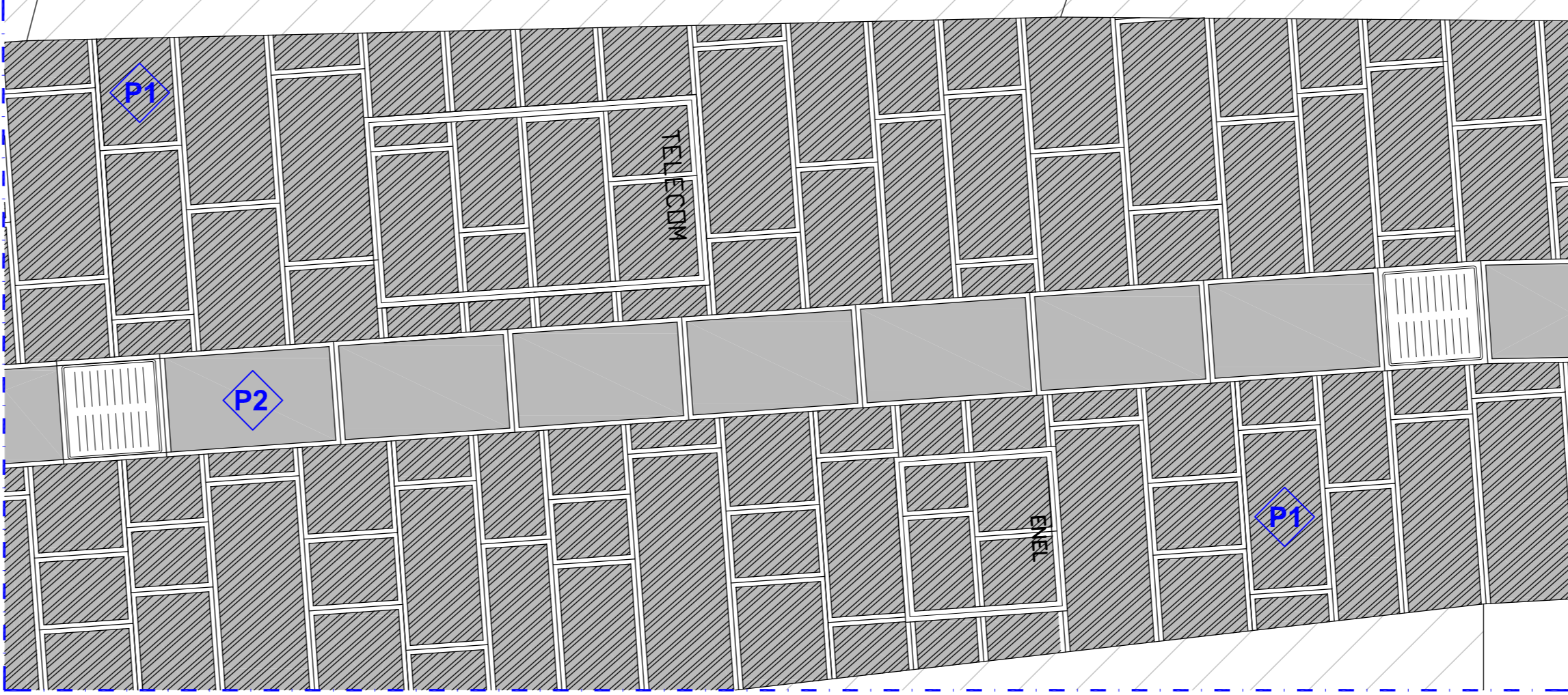
VIA EL FRATE 1° e 2° PARTICOLARE PAVIMENTAZIONE SCALA 1:20
